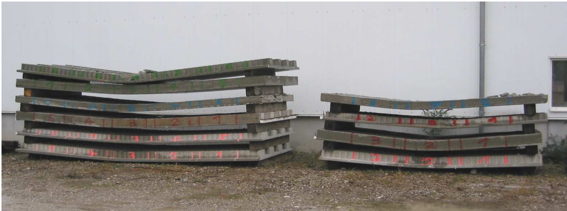
Bild 14: Stegverbundplatten nach der Versuchsdurchführung
