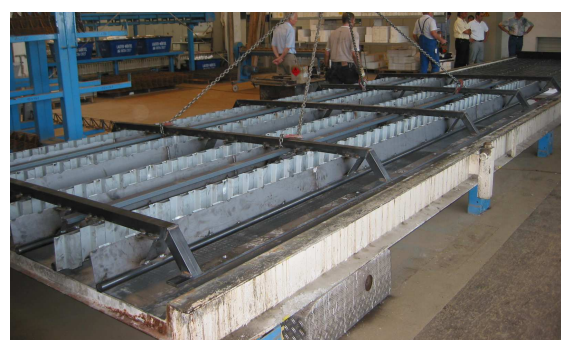
Bild 9: Prototyp einer Schalung
