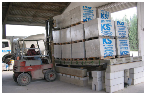
Bild 13: Belasten einer Stegverbundplatte
